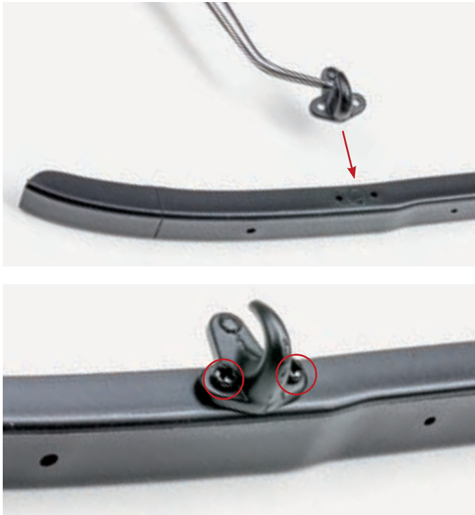
Шаг 1. Установите на верхнюю плоскость переднего бампера в его правой части буксирный крюк и закрепите его при помощи двух винтов 1,7×4 (AP).
