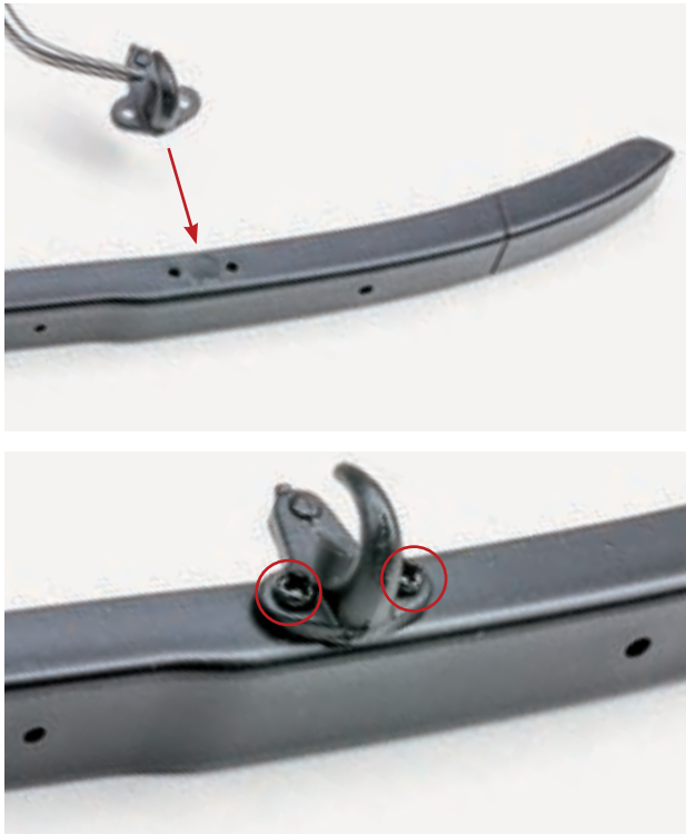
Шаг 2. Аналогичным образом закрепите двумя винтами 1,7×4 (AP) второй буксирный крюк в левой части переднего бампера.
